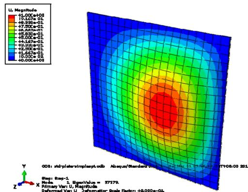
图 2: 四边简支板屈曲的有限元法模态解
