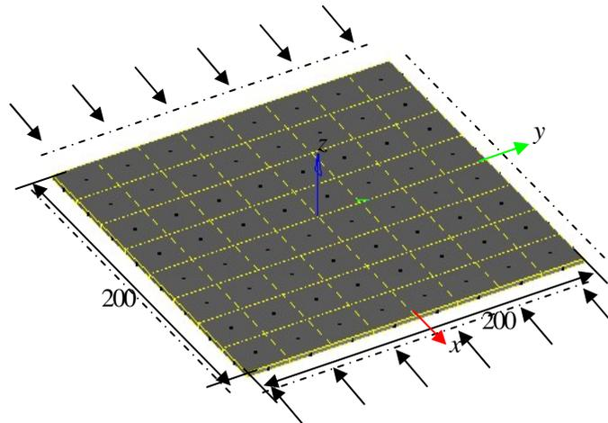
图1: 矩形板四边简支对边受压模型
